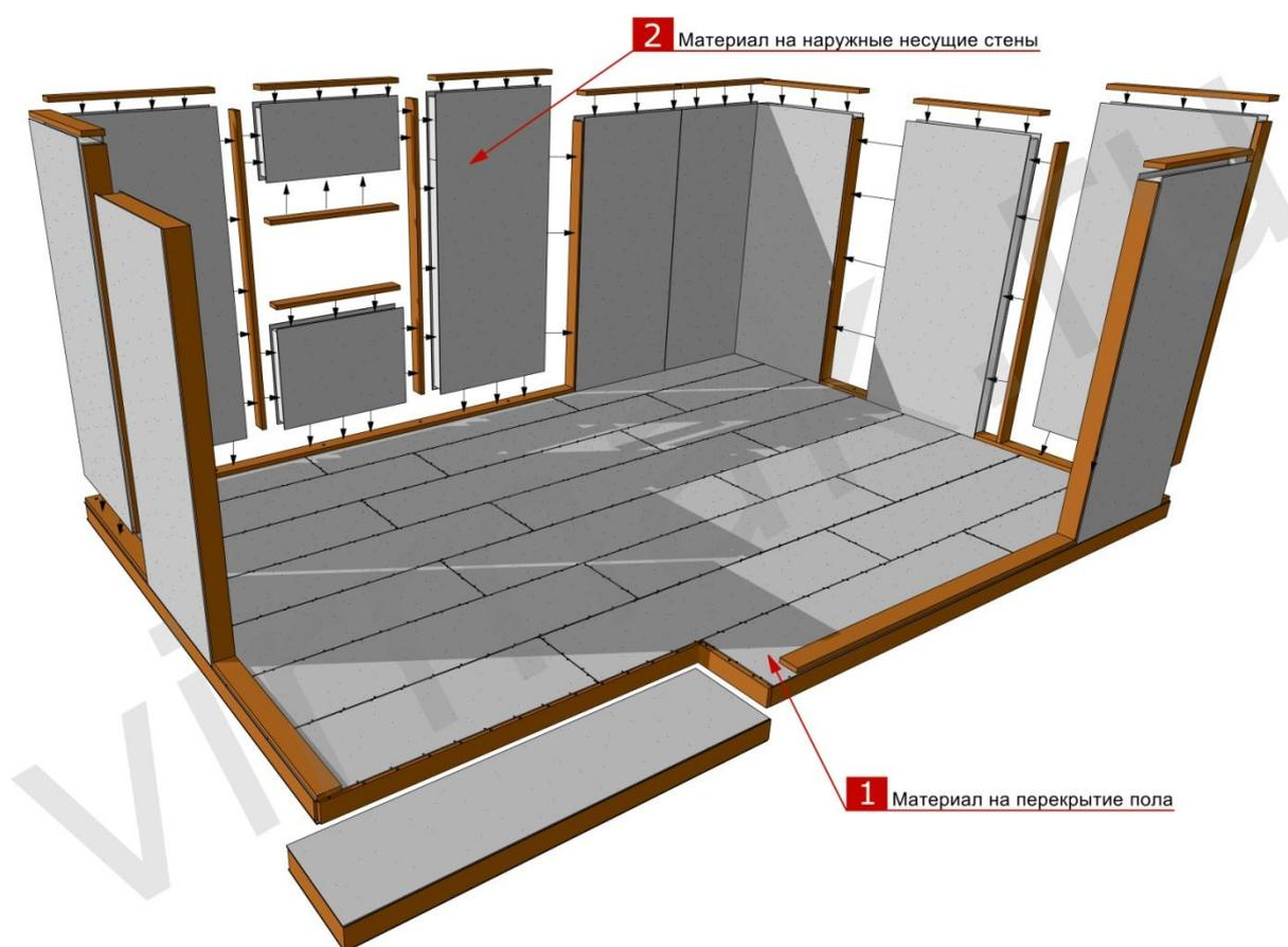
Инструкция по сборке + карта сборки; раскрой СИП панелей (распил СИП панелей согласно карты раскроя); устройство выемки (паза) в СИП панелях; зенкование в СИП панелях ЦСП листов; обрусовка СИП панелей.
